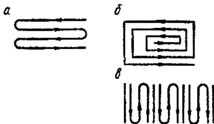
Рис.5. Последовательность забивки свай
